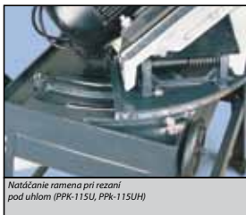
Ľahké nastavenie príťažnej sily ramena (PPK-115UH)
