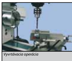
Odmontovaním nožovej hlavy máme k dispozícii zverák
