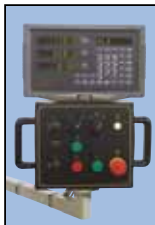
Displej digitálneho odmeriavania osi X, Y, Z
