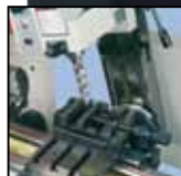
Na priečne lože je možné namontovať frézovací stôl
