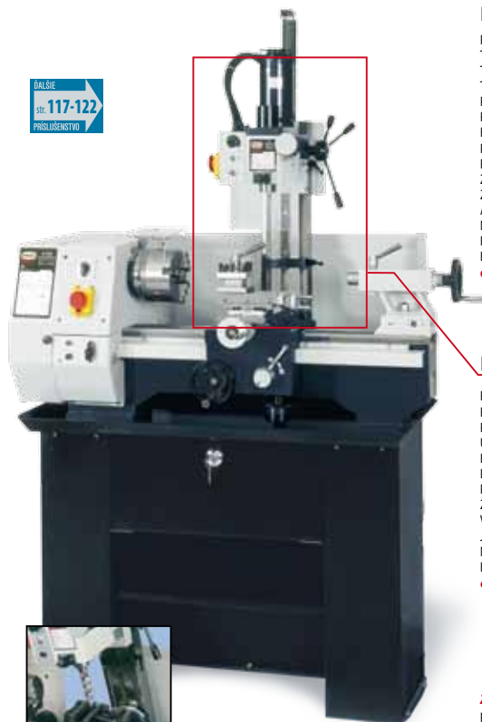
Na priečne lože je možné namontovať frézovací stôl
