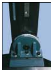
Frézku možno v pozdĺžnej rovine stola nastaviť pod uhol ± 45°
